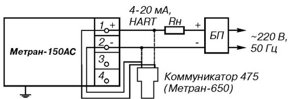
**Рис. 6-1. Выходной сигнал 4-20 мА (2-х-проводная линия связи).**
