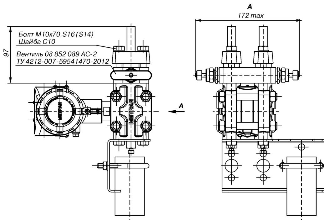
**Рис.26. Датчики мод. 150CD с установленным вентилем 08 852 089 кода V2.**
