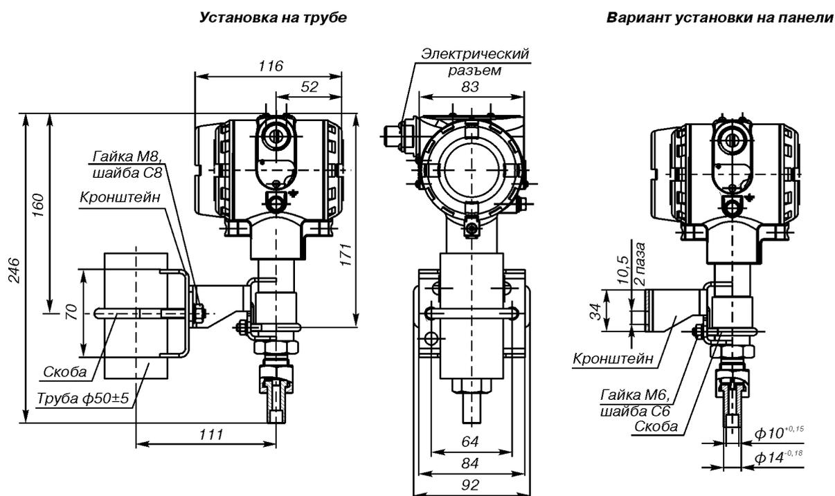
Рис.20. Датчики мод. 150TG, ТА с установленным ниппелем (код 2F) и монтажным кронштейном (код В1).
