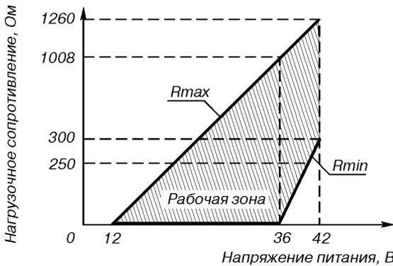
Для работы по HART-протоколу  $R_{min} = 250$  Ом
