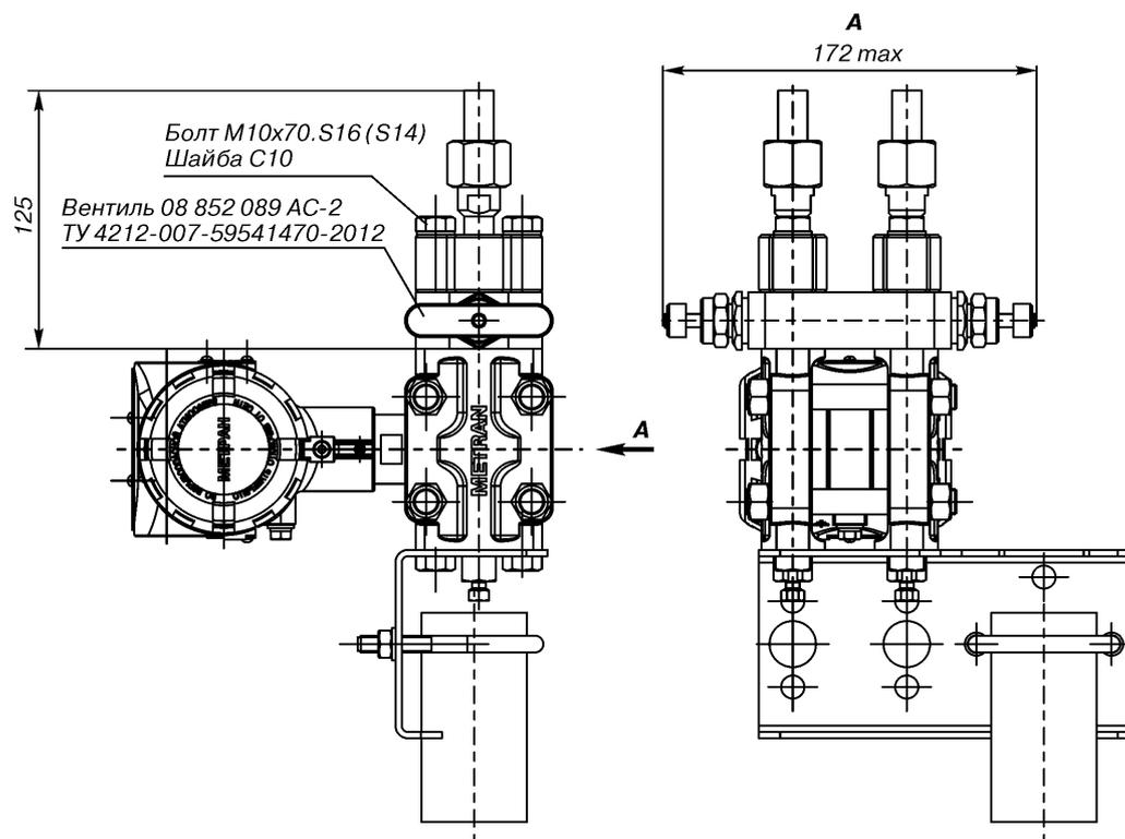
**Рис.25. Датчики мод. 150CD с установленным вентилем 08 852 089 кода V1.**
