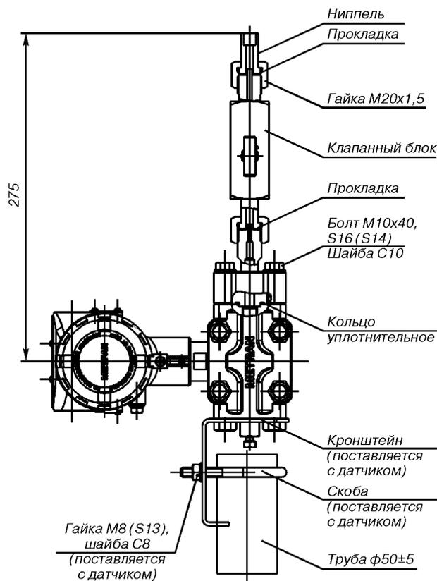
**Рис. 23. Датчики мод. 150CG с установленным клапанным блоком (коды Т4 или Т5) и монтажным кронштейном для установки датчика на трубе  $\pm 50$  мм (код В1).**
