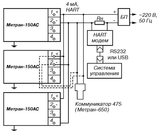
Выходной ток блока питания (БП) должен быть не менее суммарного тока потребления всех датчиков (4 мА на каждый датчик), бросок (максимальное значение) тока потребления в момент включения 25 мА на каждый датчик.
