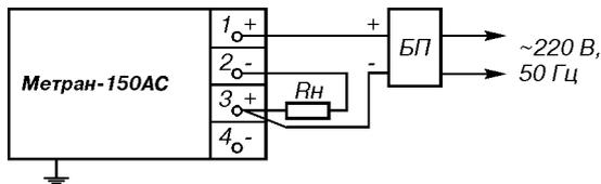
**Рис. 6-2. Выходной сигнал 4-20 мА (вариант соединения).**
