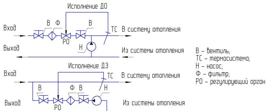
Рис. 1 Варианты возможных схем установки регулятора РТ-ДО(ДЗ)
