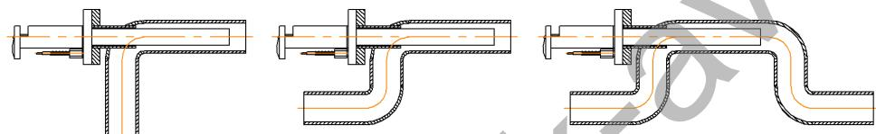
Рис. 2 Схема установки термосистемы регулятора РТ-ДО(ДЗ)
