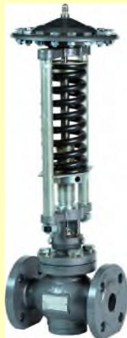
Регуляторы расхода и давления РР и РД предназначены для автоматического поддержания заданного давления или перепада давления жидких, газо- и парообразных сред, неагрессивных к материалам регулятора в условиях эксплуатации, установленных ГОСТ 12997 для группы В4. Регуляторы относятся к автоматическим устройствам прямого действия, работающим без внешнего источника энергии.
