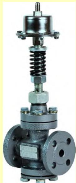
**Главная особенность регуляторов РДПД и РПДПД** — применение вместо традиционного сальникового уплотнения разделительного сильфона с дублирующим уплотняющим кольцом, что **полностью исключает** возможность протечки регулируемой среды через сальниковый узел в течение всего срока эксплуатации.
