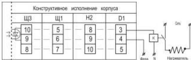
Схема подключения терморегулятора PATAP-02M.TC с симисторным выходом
