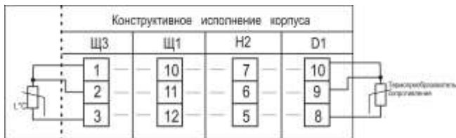
Схема подключения датчика температуры к терморегулятору PATAP-02M.TC
