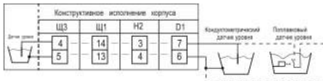
Схема подключения датчика уровня к терморегулятору РАТАР-02М.ТС
