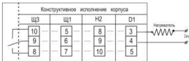
Схема подключения терморегулятора РАТАР-02М.ТС с релейным выходом
