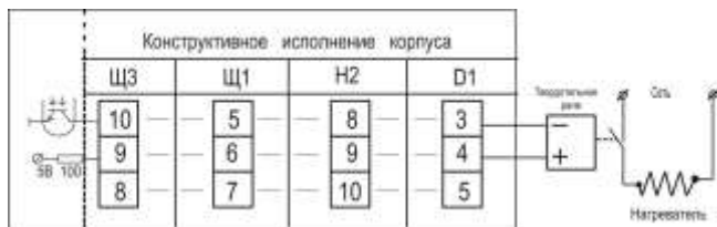
Схема подключения терморегулятора РАТАР-02М.ТС с транзисторным выходом
