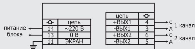
схема подключения одноканального блока
