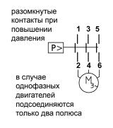
Номинальное напряжение изоляции Ui 415B~ Номинальный ток постоянной работы Ith 25A Номинальный ток AC-1 le 20A Номинальный ток AC-3 le 9A
