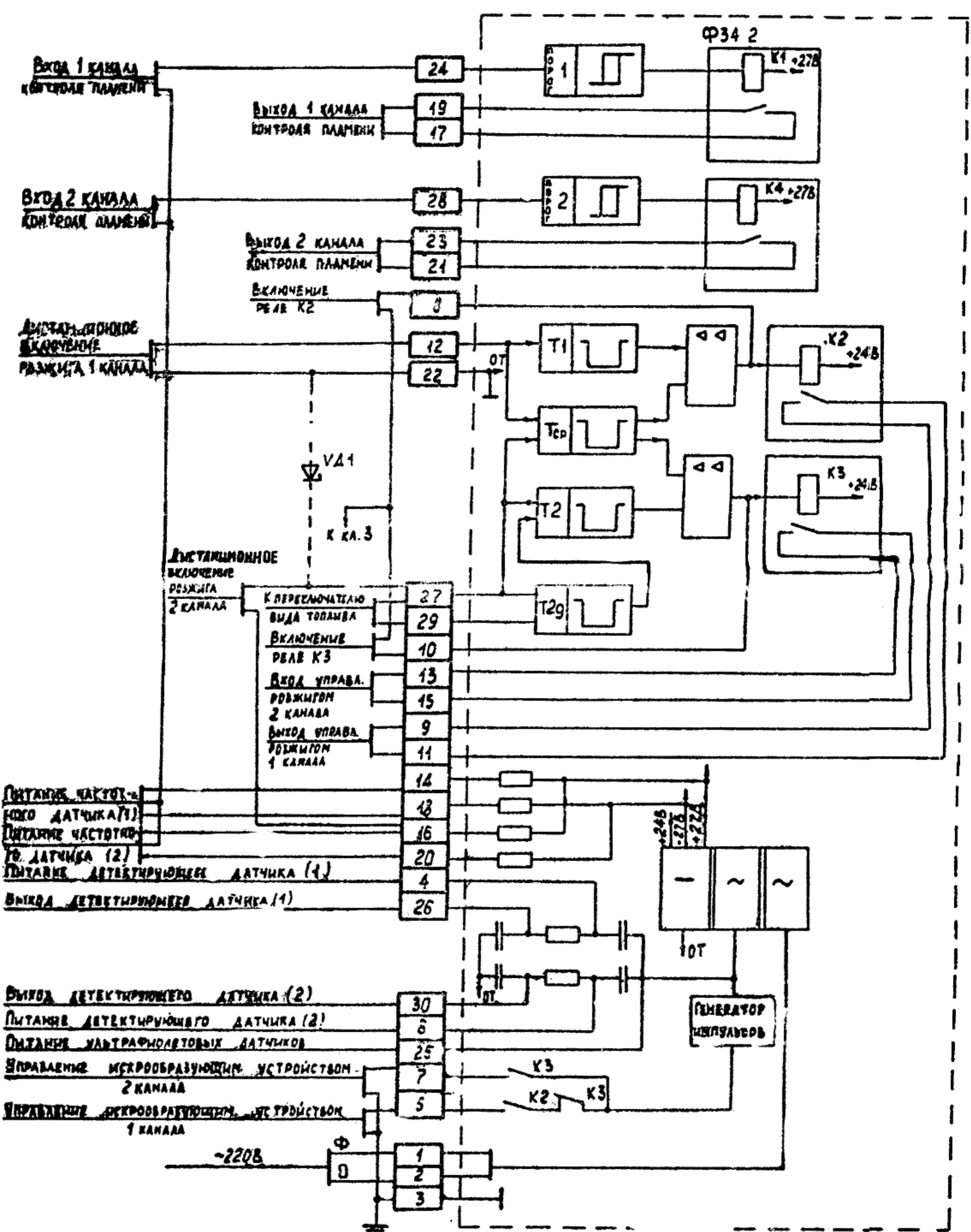
ПОДКЛЮЧЕНИЕ ЧАСТОТНЫХ И УЛЬТРАФИОЛЕТОВЫХ ДАТЧИКОВ ПАМЕНИ
