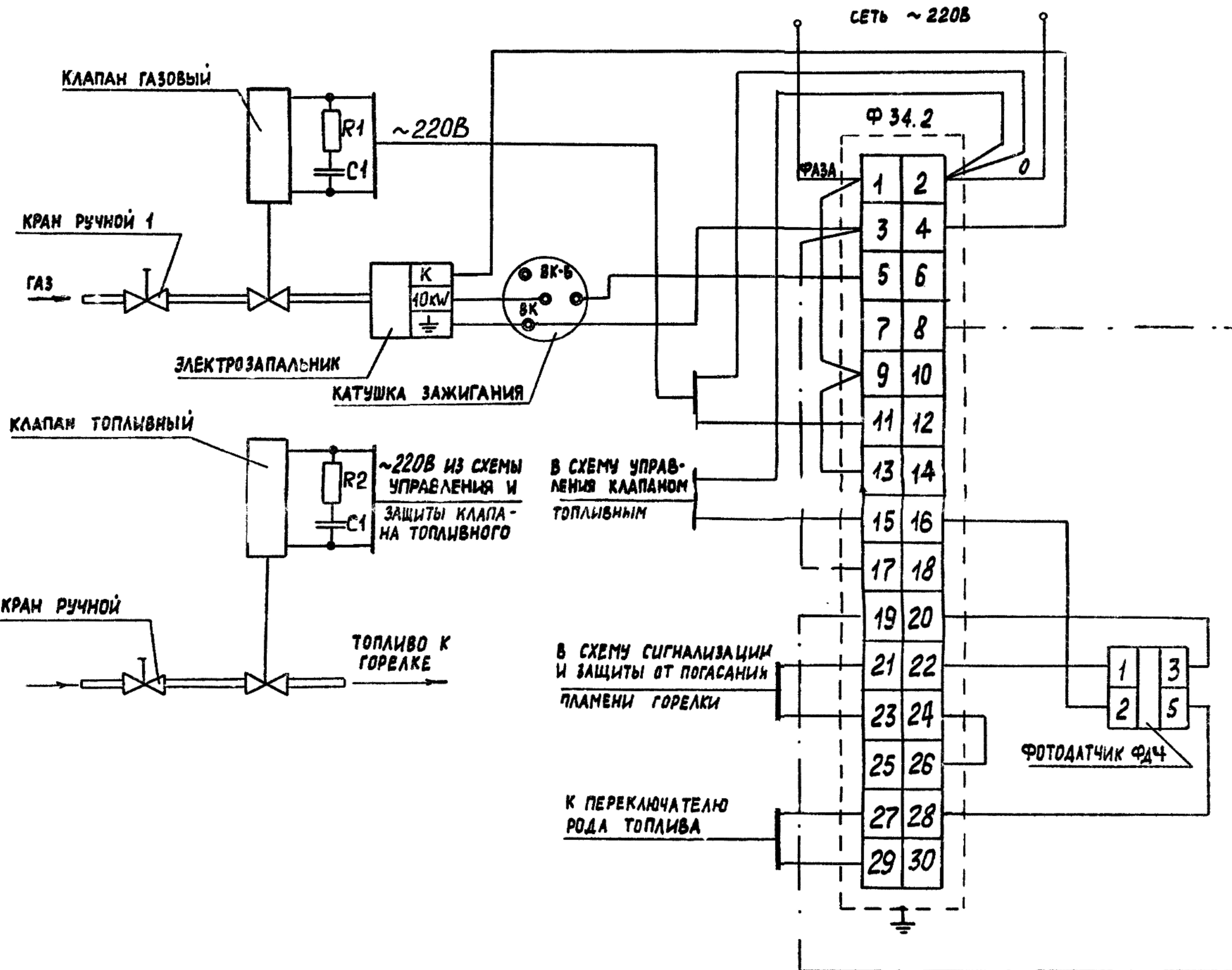
1. Дистанционное включение разжига запальника (1 канала) может быть осуществлено коммутацией клемм 12 и 22.
