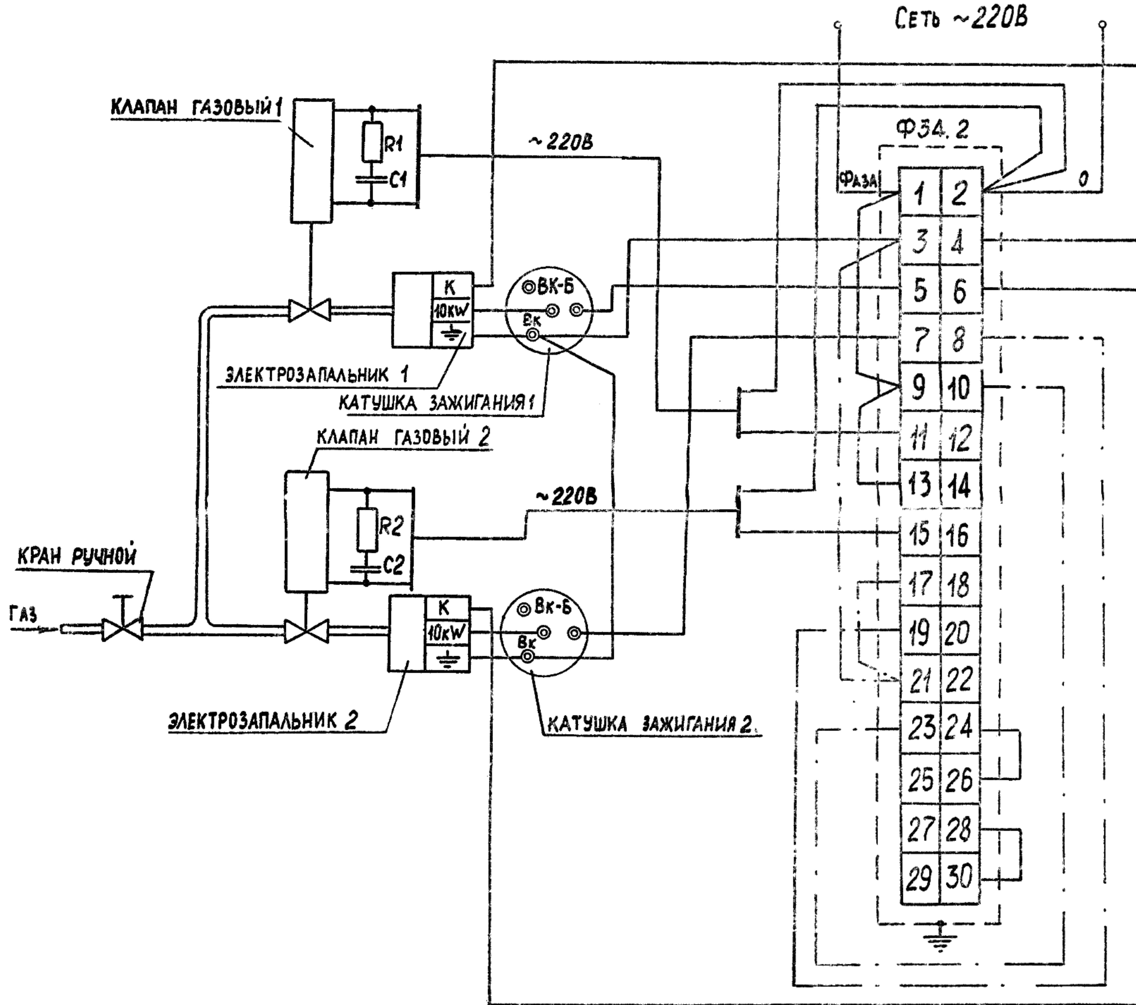
ПЕРЕМЫЧКИ, ПОКАЗАННЫЕ ШТРИХ-ПУНКТИРОМ, МОГУТ БЫТЬ УСТАНОВЛЕНЫ ДЛЯ УДЕРЖАНИЯ ПРИ НАЛИЧИИ ПЛАМЕНИ КЛАПАНОВ ГАЗОВЫХ В ОТКРЫТОМ СОСТОЯНИИ ПОСЛЕ ОКОНЧАНИЯ ВЫДЕРЖКИ ВРЕМЕНИ  $T_{ср.} \approx 150\text{с}$ .
