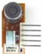
EP11 Сменный датчик для Р11 - метан.
