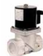
ZD... Нормально закрытые клапаны, с быстрым открытием и закрытием, с сертификатом класса А.
