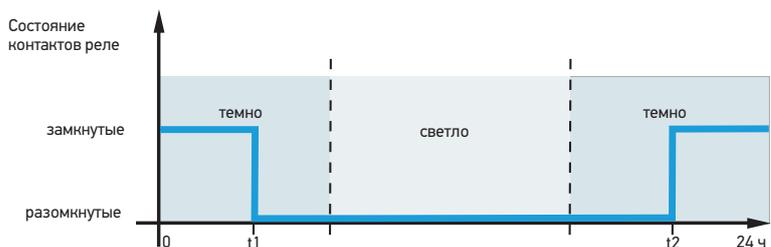
3. Работа таймера с последовательным соединением двух выходных реле (без датчика освещенности), использование нормально-замкнутых контактов реле
