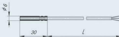
Датчик протечки ДП-1-L, L=2 м.
