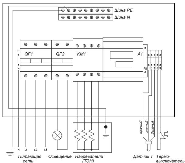
Схема подключения блока типа БУК-1-1-6,0
