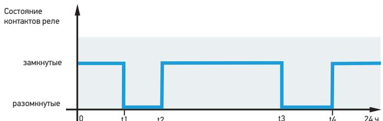
4. Работа таймера (состояние, например 1 реле) с датчиком освещенности в режиме фотореле ( $t1 = t2 = 0$ ), использование нормально-замкнутых контактов реле
