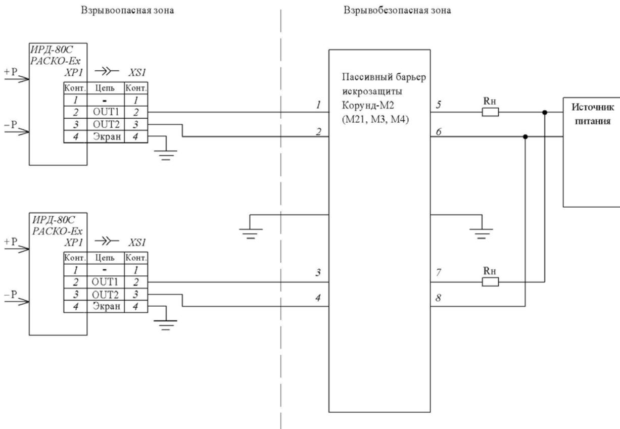
+P, -P – измеряемый параметр (давление);
