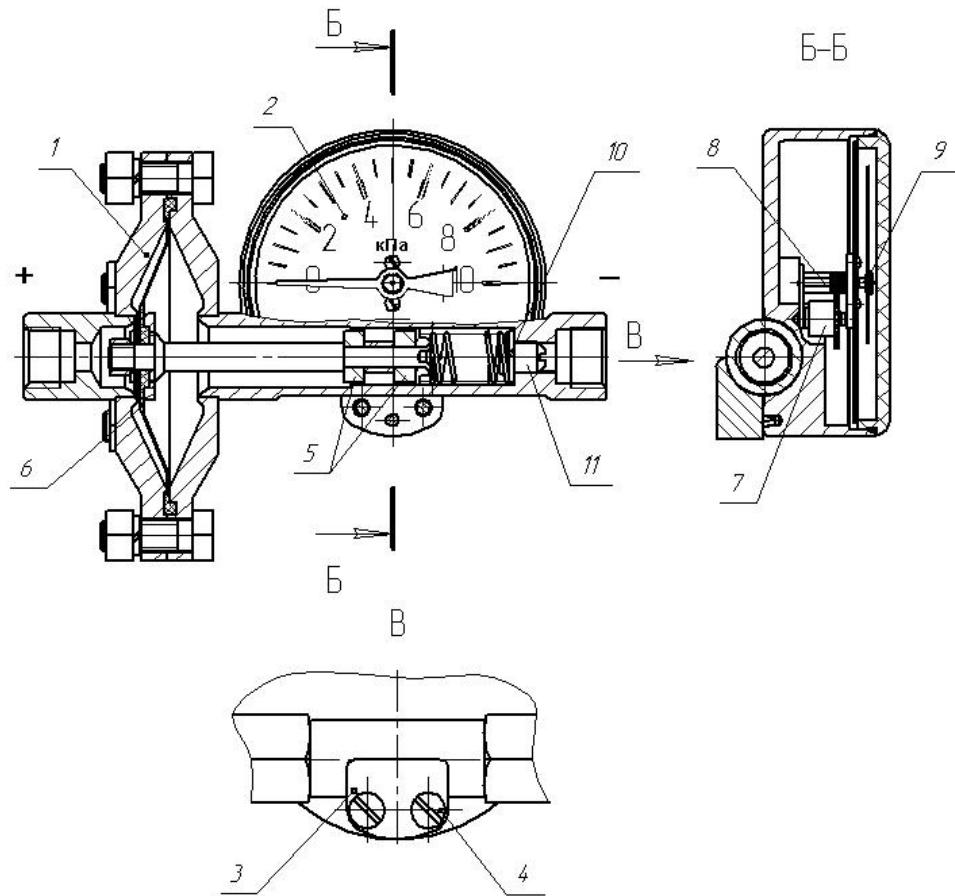
Рисунок А.1 – Конструкция индикатора
