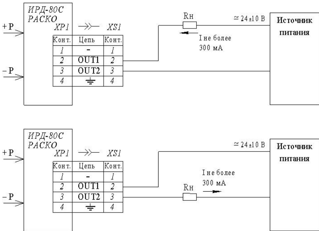
+P, -P – измеряемый параметр (давление);
