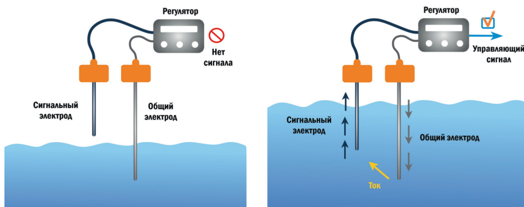
Рис. 1. Принцип работы кондуктометрических датчиков уровня
