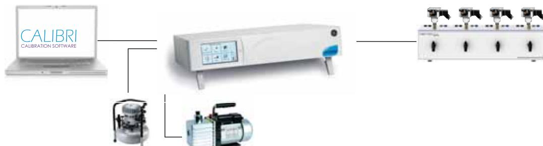
3. Автоматизированная проверка датчиков давления с распечаткой протоколов
