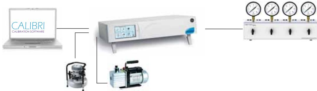
2. Проверка электроконтактных манометров, реле давления в полуавтоматическом режиме с распечаткой протоколов
