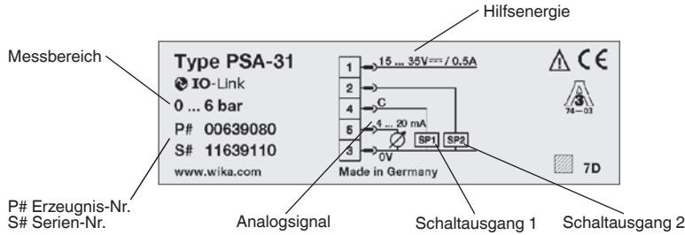
Wird die Seriennummer unleserlich (z. B. durch mechanische Beschädigung oder Übermalen), ist eine Rückverfolgbarkeit nicht mehr möglich.
