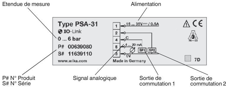
Si le numéro de série devient illisible (par ex. à cause de dommages mécaniques ou de peinture), aucune traçabilité n'est plus possible.
