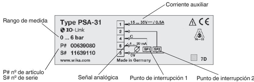
Si el número del instrumento a comprobar queda ilegible (por ejemplo por daños mecánicos o tras pintar por encima), ya no se puede mantener la trazabilidad.
