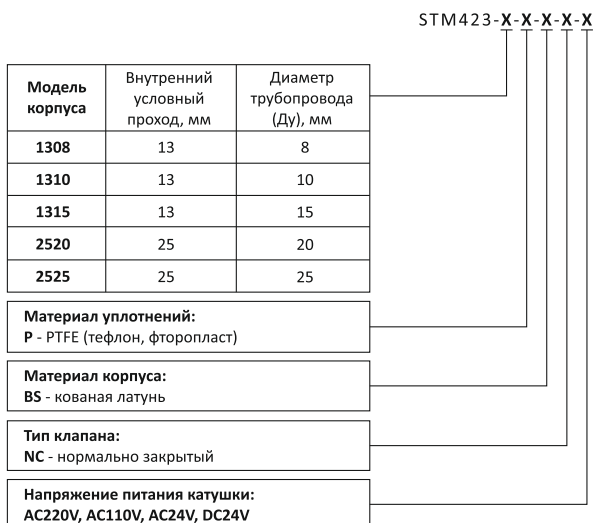
Рисунок 1. Структура условного обозначения клапанов
