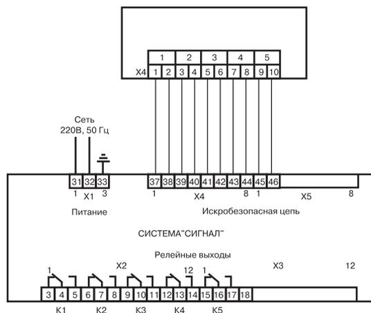
**Применяется взамен сигнализаторов уровня поплавковых типа СУЖ-ПО1, ДРУ-1ПМ, РОС 400-4,6,7.**
