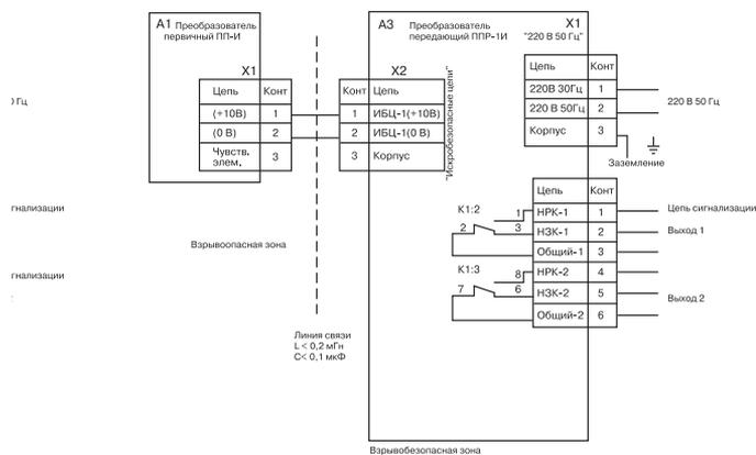
Рис. 5. Схема подключения двухканального сигнализатора (невзрывозащищенное исполнение)
