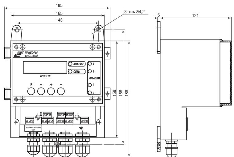
Рис.3. Габаритные и присоединительные размеры преобразователя передающего (ППР)
