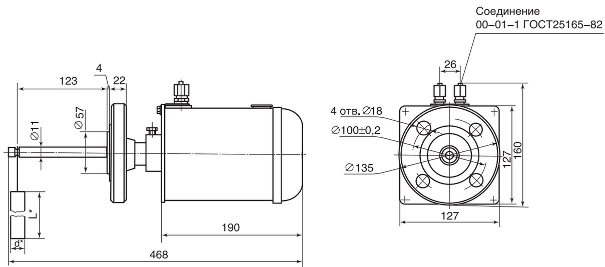
Рис. 3. Схема установки преобразователя на объекте
