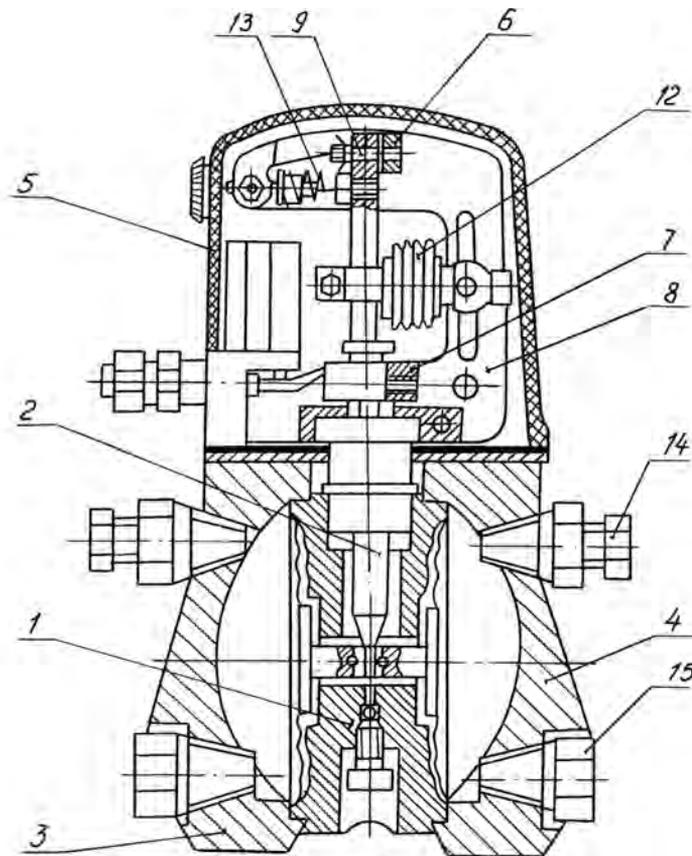
Измерительный преобразователь разности давления 13ДД11
