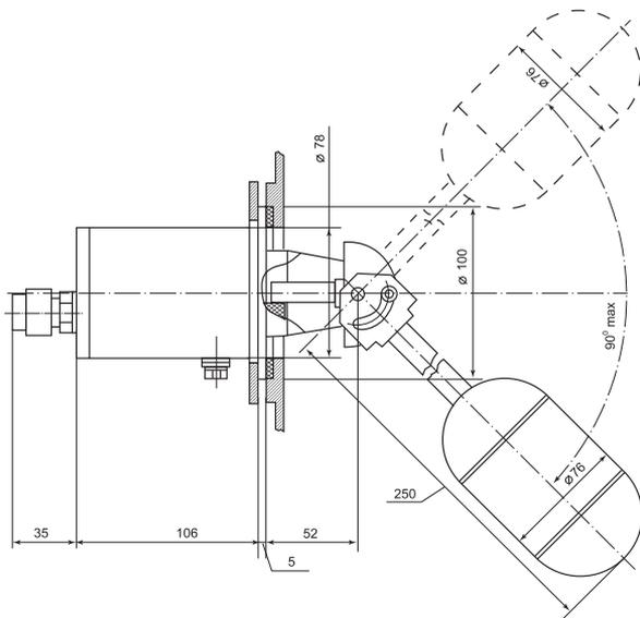
При изменении уровня жидкости происходит изменение положения поплавка, связанного с постоянным магнитом.
