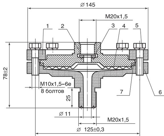
Рис. 6. Рукав соединительный гибкий. Габаритные и присоединительные размеры
