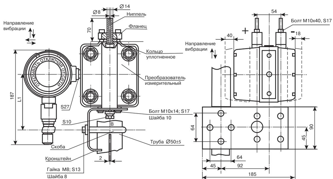
Рис.10. Габаритные, установочные и присоединительные размеры преобразователей Сапфир-22МПС моделей 2520, 2530, 2540 в исполнении «искробезопасная электрическая цепь» или в невзрывозащищенном исполнении
