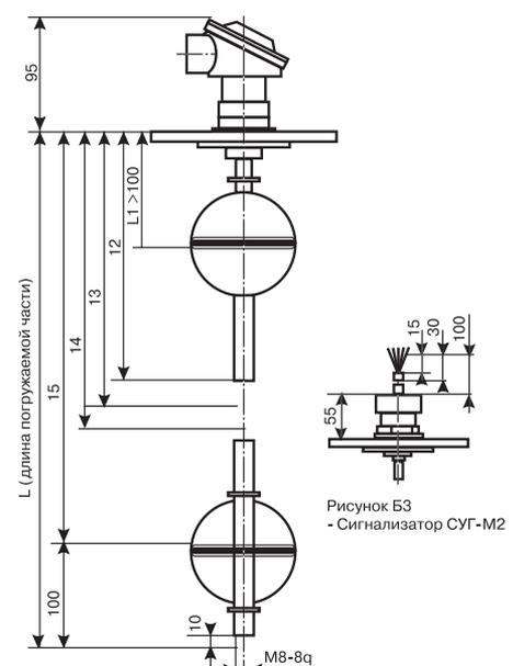
Рисунок Б3 - Сигнализатор СУГ-М2
