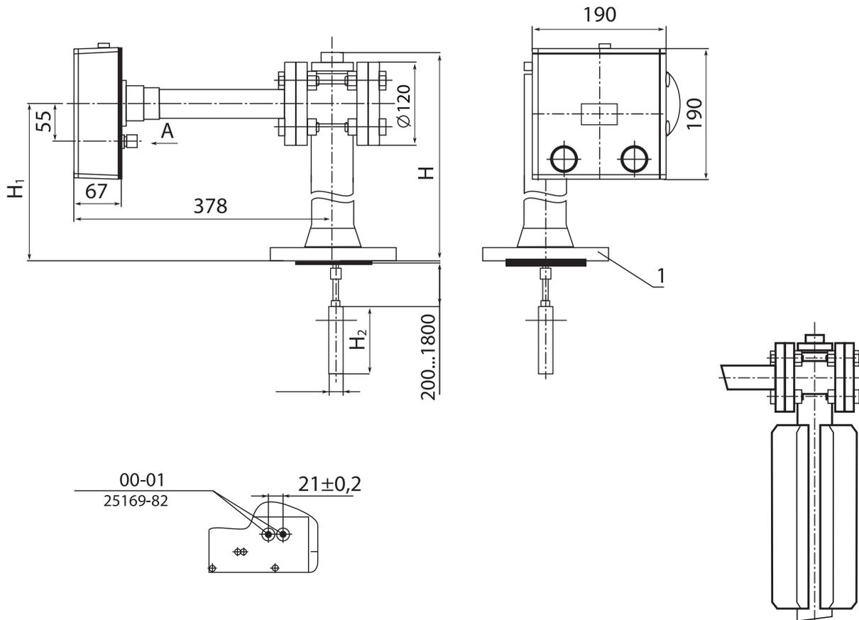
2б - с патрубком с теплоотводящими ребрами
