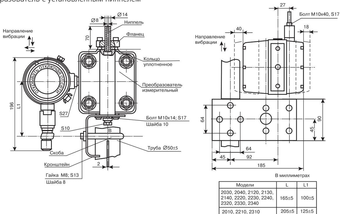
Рис.4. Габаритные, установочные и присоединительные размеры преобразователей Сапфир-22МПС моделей 2050, 2150, 2160, 2170, 2350 в исполнении «искробезопасная электрическая цепь» или в невзрывозащищенном исполнении
