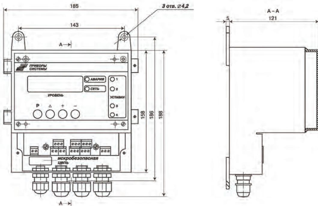
Рис. 3. Габаритные и установочные размеры фланца монтажного
