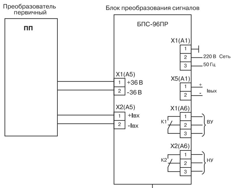
Рис. 4. Схема электрическая подключения блока БПС-96ПР-И
