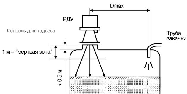
Диаметр (D) радиолуча на различных расстояниях от датчика:
