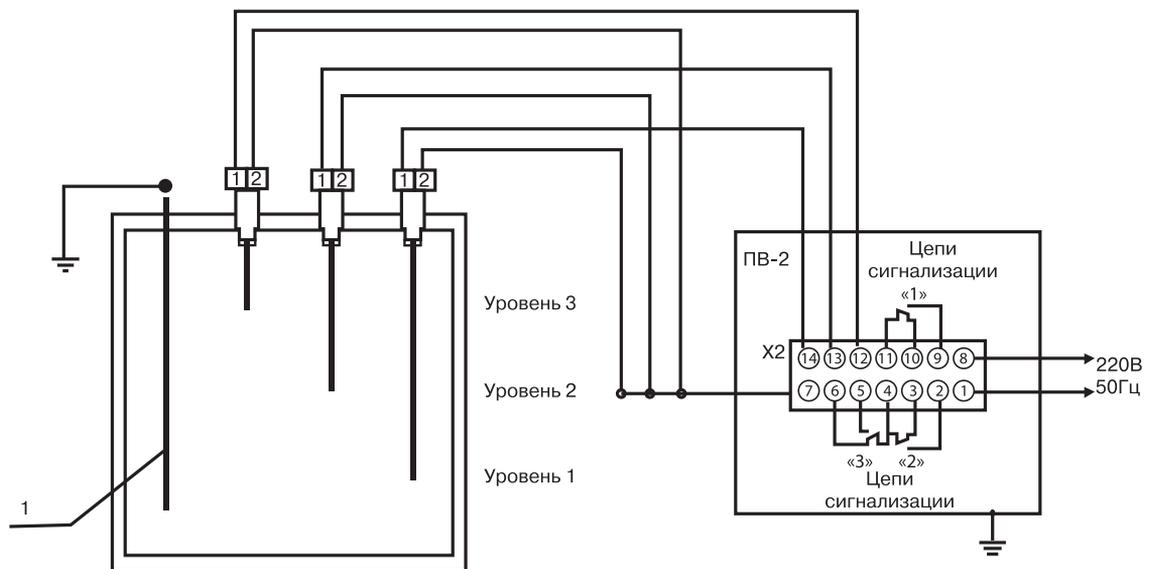
б) -Вариант схемы подключения прибора для резервуара из непроводящего материала
