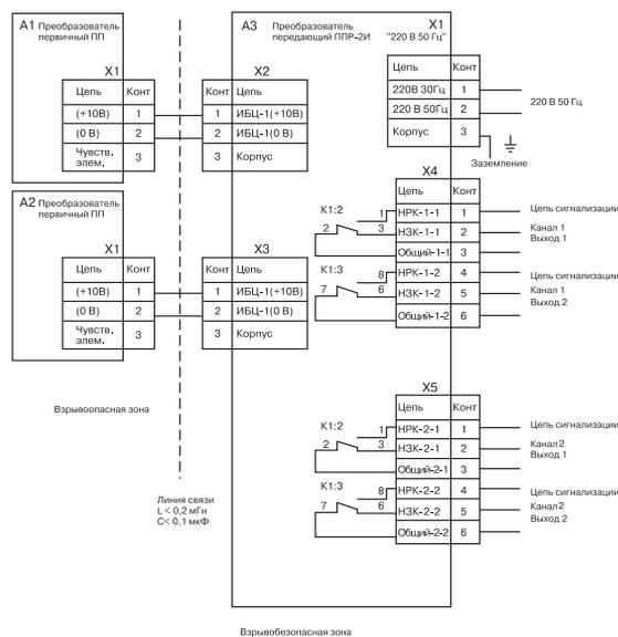
Рис.7. Схема подключения сигнализатора с ПП-015И.
