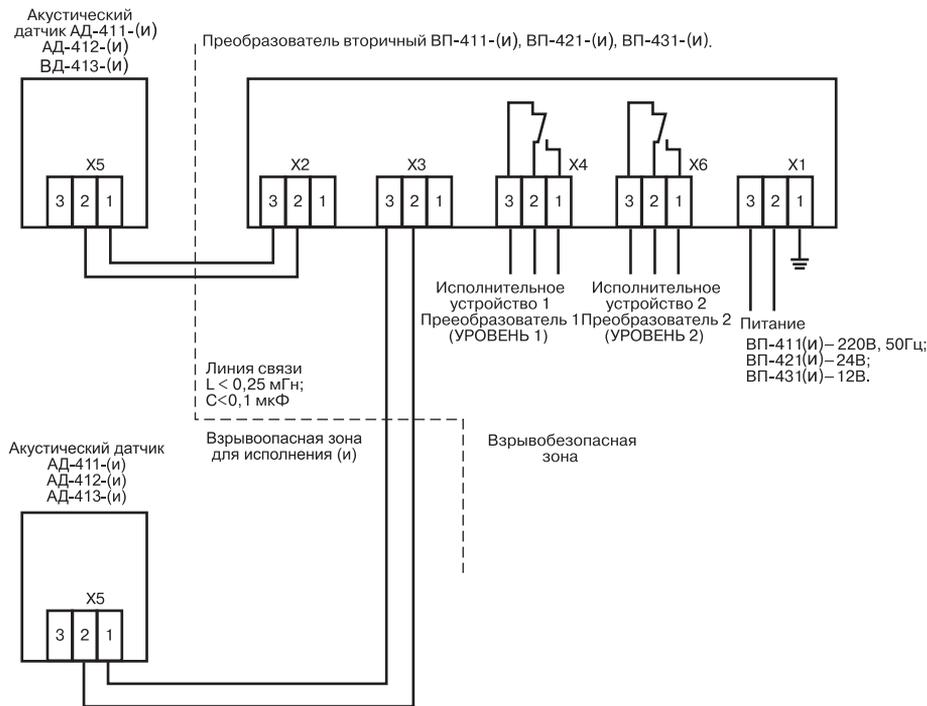
Рис. 3в. Контроль четырех уровней двумя датчиками
