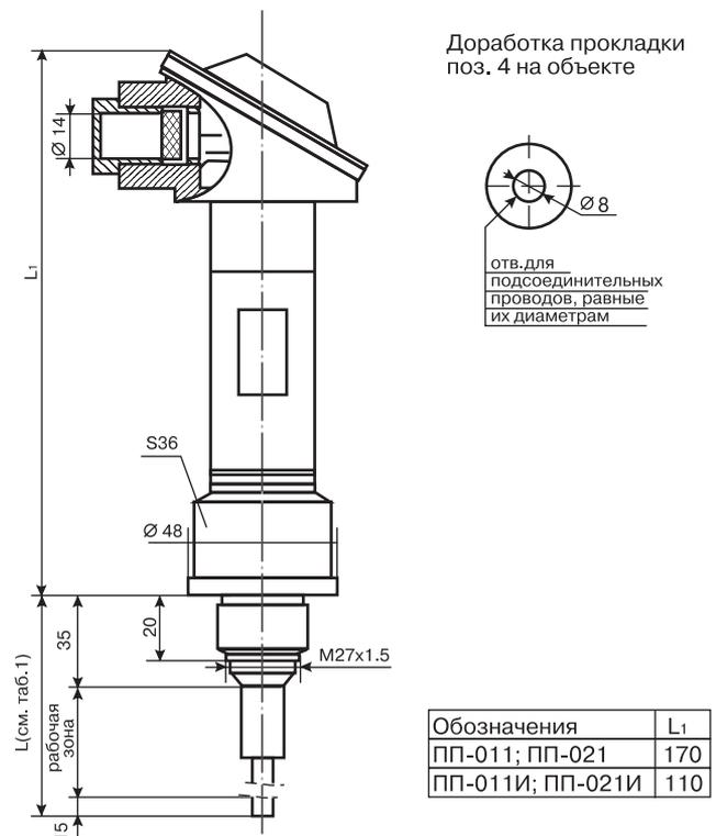
Рис. 2. Габаритные и установочные размеры первичных преобразователей
