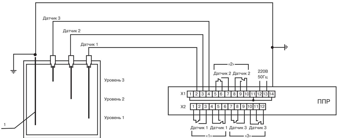
б) - Вариант схемы подключения прибора для резервуара из непроводящего материала
