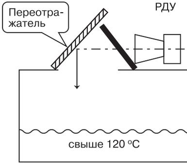
**Способы установки датчика для контроля сред с высокими температурами**
