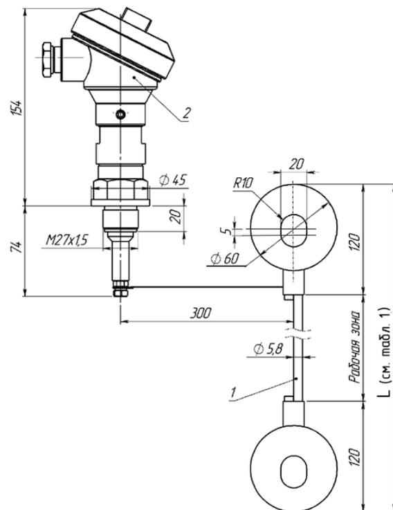
Рис. 2. Габаритные и установочные размеры преобразователя передающего
