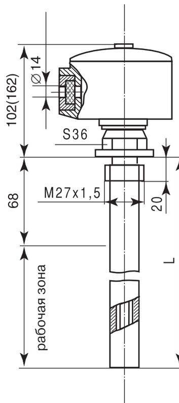
Рис. 5. Общий вид, габаритные и установочные размеры СУС-181Р(Б)
