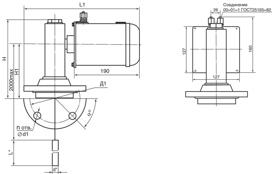
Рис. 2. Габаритные, установочные и присоединительные размеры преобразователей ПИУП-М-11, ПИУП-М-21
