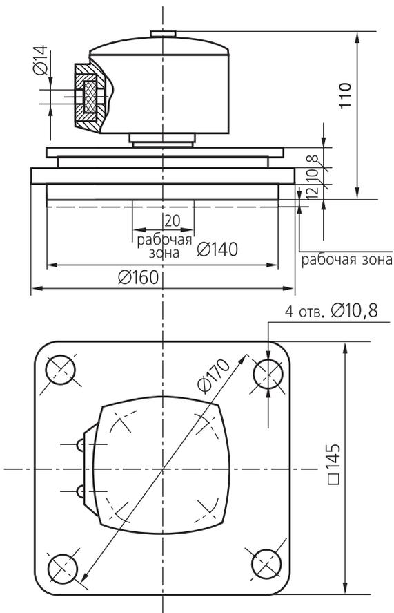
Рис. 4. Общий вид, габаритные и установочные размеры СУС-171Р(Б)
