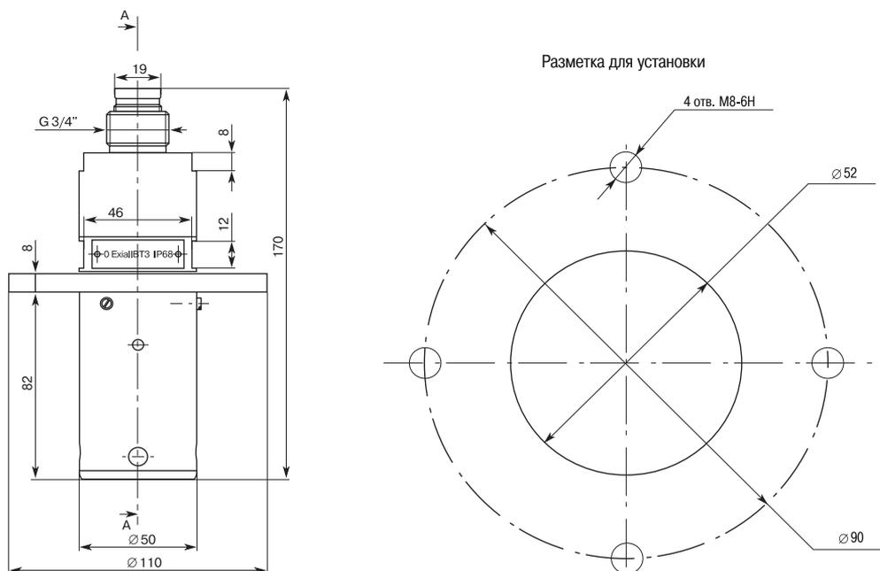
Рис.2. Габаритные и установочные размеры пульта управления и индикации ПУИ-24
