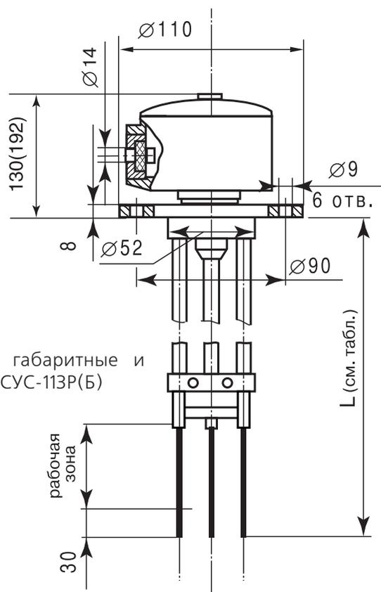
Рис. 2. Общий вид, габаритные и установочные размеры СУС-113Р(Б)
