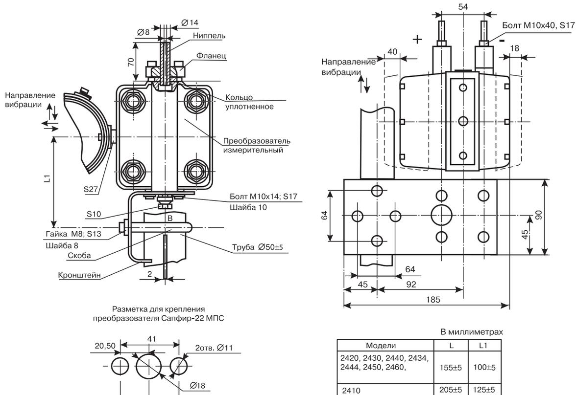
Рис.9. Габаритные, установочные и присоединительные размеры преобразователей Сапфир-22МПС моделей 2410, 2420, 2430, 2434, 2440, 2444, 2450, 2460 в исполнении «взрывонепроницаемая оболочка»
