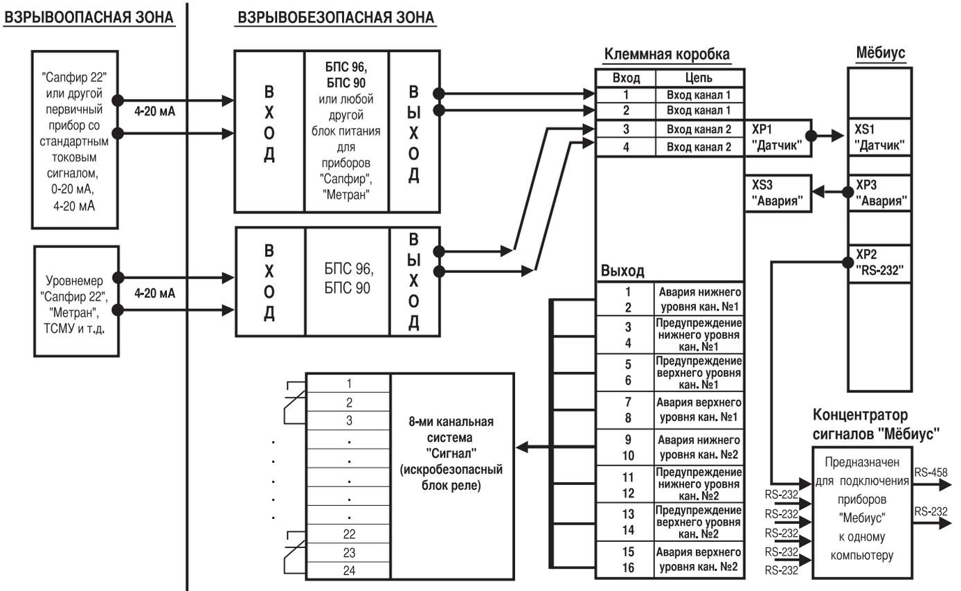
Рис. 2. Схема соединений первичных преобразователей типа «Сапфир-22», «Метран-22, 43» и др. в случае использования с устройством типа «Мёбиус».
