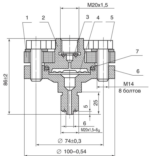
Рис. 4. Разделитель мембранный РМ модели 5322. Габаритные и присоединительные размеры
