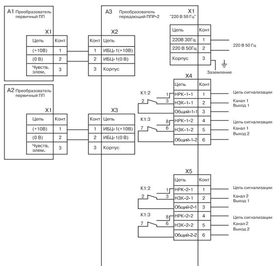
Рис. 6. Схема подключения двухканального сигнализатора (взрывозащищенное исполнение)
