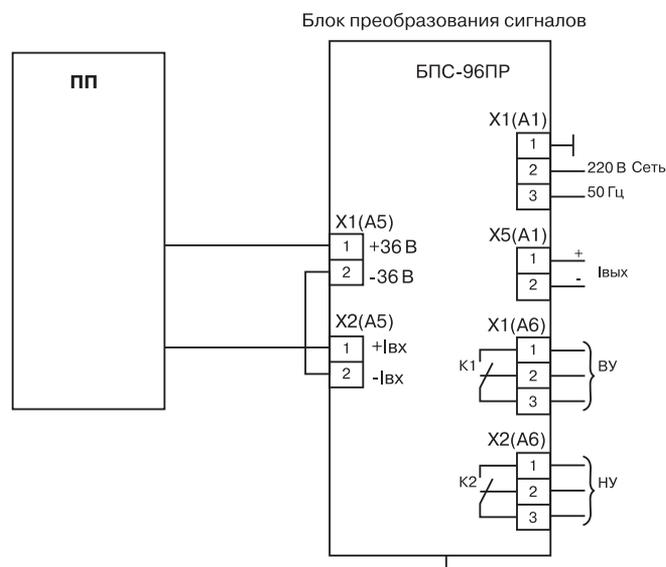
Рис. 3. Схема электрическая подключения блока при четырехпроводной линии связи
