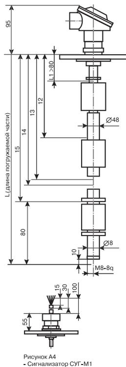
Рис. 3. Габаритные и присоединительные размеры сигнализатора уровня жидкости СУГ-М3 для среды с плотностью более 0,5 г/см<sup>3</sup>; поплавок тип II
