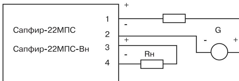
преобразователи с видом взрывозащиты "искробезопасная элетрическая сеть"
