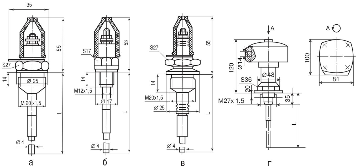
Рис. 1. Общий вид, габаритные и установочные размеры датчиков.
