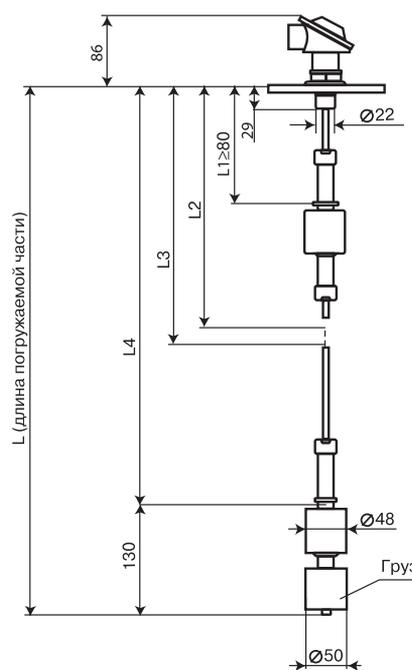
Рис. 4. Габаритные и присоединительные размеры сигнализатора уровня жидкости СУГ-М1-Г (горизонтальная установка) для среды с плотностью более 0,75 г/см<sup>3</sup>; поплавок тип I
