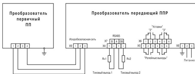
Линия связи  $R_{\text{доп}} < 20 \text{ Ом}$ ;  $L_{\text{доп}} < 0,5 \text{ мГн}$ ;  $C_{\text{доп}} < 0,1 \text{ мкФ}$
