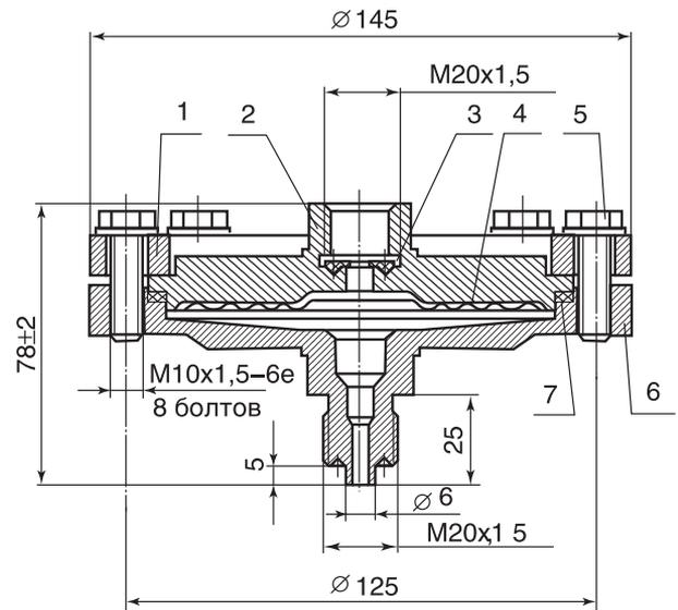
Рис. 3. Разделитель мембранный РМ модели 5321. Габаритные и присоединительные размеры
