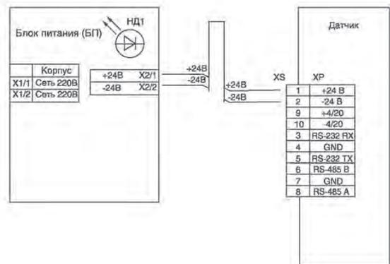
Рис. 8. Система подключения датчика РДУ-Х8-И
