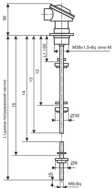
Рис. 2б. Сигнализатор СУГ-М1 с поплавком тип II, крепление на емкости посредством фланца
