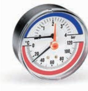
Термоманометр аксиальный. Пластмассовый корпус. Класс точности: 2,5 (давление), 2 (температура). Красная указательная стрелка. С автоматическим запорным клапаном 1/2".
