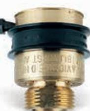
Прерыватель вакуума, предотвращающий всасывание воды обратно в магистраль питьевого водоснабжения. Рекомендуется к применению вне жилых помещений, когда вода поступает в емкость, предназначенную для мытья, полива и т.п. Имеется защита от замораживания, позволяющая опорожнить клапан. Латунный корпус, пружина из нержавеющей стали. Макс. температура воды 60 °С. Макс. рабочее давление 10 бар.
