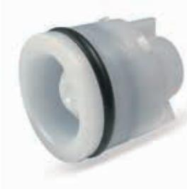
Обратный клапан. Предназначен для монтажа в водопроводную арматуру, фитинги, насосы, фильтрационное оборудование. Простой монтаж. Небольшие габариты. Низкое давление открытия. Малые потери давления. Корпус: POM. Седло: SBR Buna-S. Уплотнение: NBR Buna-N. Пружина: нержавеющая сталь. Рабочее давление: 10 бар. Макс. давление: 16 бар. Макс. рабочая температура: 90°C.
