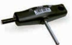
Двойной штифтовой ключ для настройки балансировочных вентилей WattFlow BP. Шестигранник на 6 используется для установки вентиля, шестигранник на 8 для функции Memostop (фиксация настройки).
