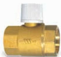
Обратный клапан с ручным запорным клапаном – для систем отопления с циркуляционным насосом, работой которого управляет термостат. Корпус из латуни CW617N, удачропочный пластмассовый маховик. Max. рабочее давление 10 бар. Давление открытия 25-26 мбар. Рабочая температура 105 °C. Max. допустимая температура 130 °C.
