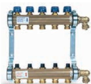
Коллектор 1" для напольного отопления, состоящий из двух профилированных латунных патрубков, смонтированных на звукоизолирующих кронштейнах, с возможностью разностороннего подключения (1" ВР с плоским уплотнением). Выходы: 3/4" НР с евроконусом, расстояние между отводами 50 мм. Минимальная величина заглубления при скрытом монтаже. Концевые группы с воздушным клапаном в комплекте.
