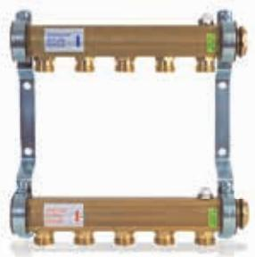
Коллектор 1" для двухтрубной радиаторной системы отопления из двух профилированных латунных патрубков, смонтированных на звукоизолирующих кронштейнах, с возможностью разностороннего подключения (1" ВР с плоским уплотнением). Выходы: 3/4" НР с евроконусом, расстояние между отводами 50 мм. Минимальная величина заглубления при скрытом монтаже. Коллектор прошел функциональные и гидравлические испытания. Концевые группы с воздушным клапаном и двумя заглушками в комплекте.
