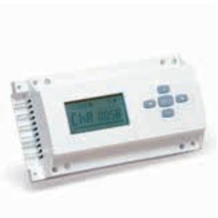
Таймер с программированием на неделю для двух зон (A и B) для систем напольного отопления. Собирается в единую модульную конструкцию с коммутационными модулями WFHC. 9 заводских и по 1 пользовательской программе для каждой зоны. Степень защиты IP30. Только для Н.З. сервоприводов.
