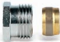
Никелированный резьбовой переходник с металлическим уплотнением для присоединения медной трубы (толщина стенки 1 мм) к радиаторным регулирующим и отсечным вентилям с внутренней резьбой.
