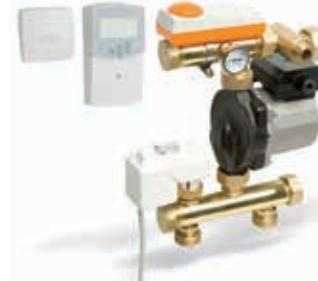
Готовый к монтажу, компактный регулирующий модуль для систем напольного отопления тепловой мощностью до 14 кВт. Температура подачи регулируется при помощи погодозависимого, входящего в комплект поставки контроллера Climatic Control по температурной кривой. Поставляется с готовым электрическим подключением насоса и ограничителем температуры. Накидные гайки с плоским уплотнением для монтажа с обеих сторон на 1" коллекторных патрубков. Прошел тест на давление, упакован в коробку.
