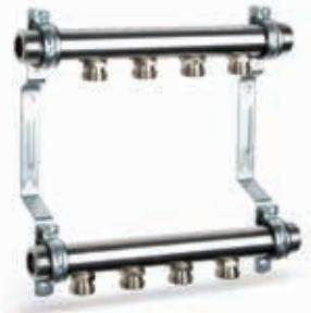
Коллектор 1" для двухтрубной радиаторной системы отопления, состоящий из двух патрубков из нержавеющей стали, смонтирован на звукоизолирующих кронштейнах, с возможностью разностороннего подключения (1" НР с плоским уплотнением). Выходы: 3/4" НР с евроконусом, расстояние между отводами 50 мм. Минимальная величина заглубления при скрытом монтаже. Коллектор прошел функциональные и гидравлические испытания.
