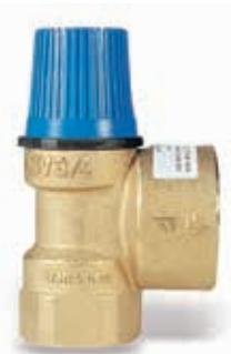
Предохранительный сбросной мембранный клапан с фиксированным порогом срабатывания (сбросное отверстие на один размер больше присоединительного). Корпус из латуни CW617N. Пластмассовый колпачок для ручного сброса. Никель-хромированная стальная пружина. Максимальная рабочая температура 110 °C. Внутренняя резьба, в присоединительном и сбросном отверстиях.
