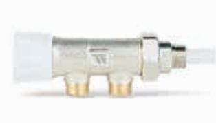
Четырехходовой, никелированный, ручной вентиль для однотрубных систем. 1/2"НР под обжимной фитинг полимерной или медной трубы. Разъемный штуцер с уплотнением для подключения к радиатору, в комплекте с погружным патрубком для разделения потоков. Распределение расхода на каждый последовательный радиатор: 100%. Пластмассовый маховик.
