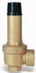
Предохранительный сбросной мембранный клапан с фиксированным порогом срабатывания (сбросное отверстие на один размер больше присоединительного). Корпус из латуни CW617N. Рабочее давление 10 бар. Допустимое превышение давления 10%. Порог срабатывания при превышении до 20%. Максимальная рабочая температура 120 °C. Внутренняя резьба, в присоединительном и сбросном отверстиях.
