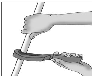
Отрезать трубу, под прямым углом, избегая заусенцев, используя специальные ножницы.
