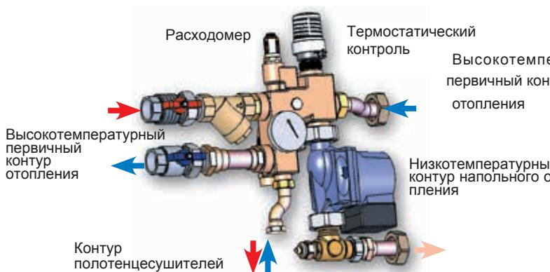
Рис. 1 - DOMORADIANT с фиксированным температурным контролем
