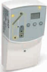
Контроллер LED для гелиосистем, состоящих из одного коллектора, одного гидроаккумулятора и одного насоса. Светодиоды на дисплее показывают состояние насоса и двух температурных датчиков. В комплект поставки входят 2 датчика PT1000/SF3 (длина кабеля 3м) и 1 датчик x PT1000/KS1,5 (длина кабеля 1,5м). Электропитание 230 VAC. Класс защиты IP42.
