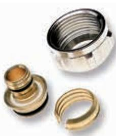
Резьбовое соединение с евроконусом для труб из поперечношитого полиэтилена и металлопластиковых труб, служит адаптером для коллекторов HKV и узлов нижнего подключения радиатора. Состоит из евроконусного штуцера с уплотнениями (антагальваническая изоляция), накидной гайки 3/4" и разрезного кольца. В упаковке две штуки.
