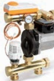
Готовый к монтажу, компактный регулирующий модуль для систем напольного отопления тепловой мощностью до 14 кВт. Диапазон регулирования температуры подачи 20 - 70°C. Встроенный термометр показывает текущее значение температуры подачи. Поставляется с готовым электрическим подключением насоса и ограничителем температуры. Накидные гайки с плоским уплотнением для монтажа с обеих сторон на 1" коллекторных патрубков. Прошел тест на давление, упакован в коробку.
