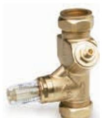
Балансировочный вентиль WattFlow BP со встроенным расходомером (обжимные фитинги под медную трубу). Регулирование расхода с визуальной индикацией текущего значения расхода. Широкий диапазон измерения расхода. Нет необходимости в использовании диаграмм и дополнительных устройств. Любое монтажное положение. Малая монтажная длина. Корпус – латунь, шкала – ударопрочная пластмасса. Нет необходимости в поправочных коэффициентах в случае добавки антифриза в теплоноситель.
