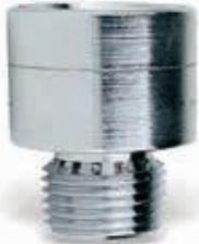
Прерыватель вакуума, предотвращающий всасывание воды от конечного пользователя обратно в магистраль питьевого водоснабжения. Рекомендуется как минимальный барьер безопасности во всех ситуациях, когда конец шланга подачи питьевой воды погружен в ванну или раковину. Хромированный латунный корпус, пружина из нержавеющей стали. Макс. температура воды 60 °С. Макс. рабочее давление 10 бар.
