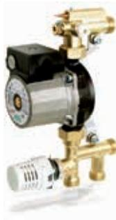
Готовый к монтажу компактный регулирующий модуль для полов небольшой площади (до 50м<sup>2</sup> или 5 кВт). Количество контуров отопления может быть увеличено до 3 - 4 петель одинаковой длины. Диапазон регулирования температуры подачи 20 - 50 °C. Поставляется с готовым электрическим подключением насоса и ограничителем температуры.
