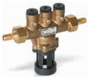
Компактный прерыватель обратного потока с регулируемой зоной пониженного давления. DN 6-10. Макс. температура воды 65 °C (допустима температура до 90 °C не более одного часа в день). Макс. рабочее давление 10 бар. Корпус – латунь DZR CW602N. Перед прерывателем обратного потока обязательно должен устанавливаться фильтр механической очистки F21NOR.
