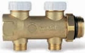
Одиночный модульный латунный коллектор подающего трубопровода с предустановленными уплотнениями и фиксирующей гайкой. Встроенные фиксирующие вентили гидравлической балансировки. Kvs на отводах петель отопления: 2,61.
