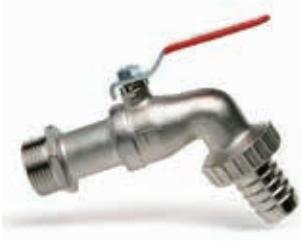
Сливной шаровый кран из латуни, полнопроходной, угловой, никелированный, резьбовое присоединение нарезного штуцера для шланга, ручка стальная. Усиленная конструкция. Рабочее давление до 20 бар. Максимальная температура 110 °C.
