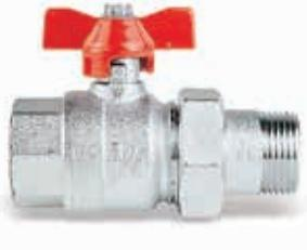
Шаровый кран для присоединения коллекторов питьевого водоснабжения. Макс. давление 25 бар (до 95 °C), 16 бар (до 120 °C).
