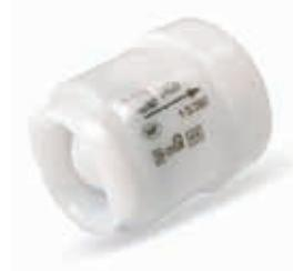
Обратный клапан. Для монтажа в водосчетчики. Простой монтаж. Небольшие габариты. Низкое давление открытия. Малые потери давления. Корпус: POM. Седло: SBR Buna-S. Уплотнение: NBR Buna-N. Пружина: нержавеющая сталь. Рабочее давление: 10 бар. Макс. давление: 16 бар. Макс. рабочая температура: 90°C.
