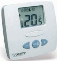
Электронный комнатный радиотермостат с ЖК-дисплеем. Режимы работы: комфортный, ночной. Диапазон регулирования: 5 - 30°C. Гистерезис 0,3К или ПИ-регулирование.
