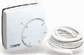
Электронный комнатный термостат для систем напольного отопления. Режимы работы: комфортный, ночной, управление от таймера. Светодиодная индикация состояния. Диапазон регулирования 5 – 30 °C, гистерезис 0,5К или ПИ-регулирование. Датчик пола в комплекте: пределы регулирования 10 - 40 °C, кабель 3м.
