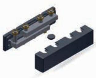
Готовый к монтажу, компактный коллектор для подключения насосных модулей **PAS**, **PASM** и **HKF** как DN25, так и DN32. Самоуплотняющиеся подключения с накидными гайками 1.1/2" для насосных модулей, подключение к первичному контуру 1.1/2" HP. Изоляционный кожух из вспененного полипропилена EPP с межкамерной вкладкой (термическое разделение камер подающей и обратной линии).
