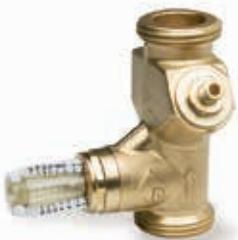
Балансировочный вентиль WattFlow BP со встроенным расходомером (наружная резьба). Регулирование расхода с визуальной индикацией текущего значения расхода. Широкий диапазон измерения расхода. Нет необходимости в использовании диаграмм и дополнительных устройств. Любое монтажное положение. Малая монтажная длина. Корпус – латунь, шкала – ударопрочная пластмасса. Нет необходимости в поправочных коэффициентах в случае добавки антифриза в теплоноситель.
