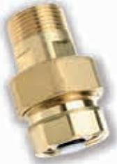
Муфтовое соединение для гелиосистем – для быстрого отсоединения и замены расширительных баков без опорожнения системы, температура до 160 °C.
