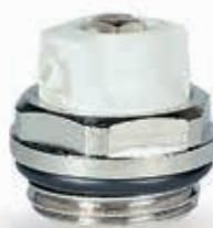
Ручной воздушник – клапан Маевского, самоуплотняющийся. Вращаемый пластмассовый "носик", корпус – латунь с никелевым покрытием.
