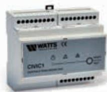
Центральное устройство для подключения детекторов утечки газа UR13 или UR 20S с светодиодной индикацией (электропитание, сбой, газовая сигнализация) и звуковой сигнализацией. Управляющий выход для газовой сигнализации и выход с открытым коллектором для сигнала сбоя. Корпус из самогасящегося пластика. Монта на рейке DIN.
