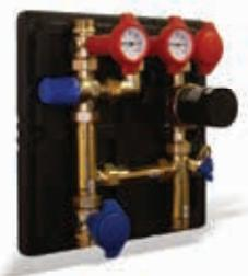
Готовый к монтажу компактный модуль циркуляции. Применяется в системах ГВС со стабильно высокими температурами. Включает в себя: подмешивающий клапан MMV для защиты от ожогов, запорную арматуру и прерывателя обратного потока. Изоляция из EPP. Циркуляционный насос для водоснабжения.
