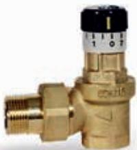
Перепускной клапан. Малый вес. Max. рабочее давление 10 бар. Max. рабочая температура 110°C. Диапазон регулирования 0,06 – 0,36 бар. Допустимо использование с антифризом (гликоль до 50%).
