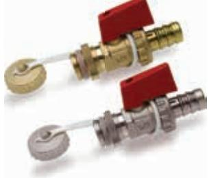
Самоуплотняющийся латунный шаровый кран DN 15 (1/2") для заполнения и дренажа. Полнопроходное исполнение, давление до 16 бар, температура до 110 °C, штуцер под шланг.
