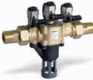
Компактный прерыватель обратного потока с регулируемой зоной пониженного давления. DN15-50. Макс. температура воды 65 °C (допустима температура до 90 °C не более одного часа в день). Макс. рабочее давление 10 бар. Корпус – латунь DZR CW602N. Перед прерывателем обратного тока обязательно должен устанавливаться фильтр механической очистки F21NOR.
