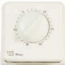
Электромеханический комнатный термостат с термочувствительной диафрагмой, имеет три контакта. Диафрагма из нержавеющей стали. Фиксация установленной температуры на обратной стороне вращаемого регулятора. Диапазон регулирования: 5-30 °C. Гистерезис при 20 °C составляет 0,8 К. На контактах до: 10 (2,5) A – 250 В. Контакты с серебряным покрытием 1000-1000.
