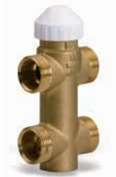
Трехходовой латунный зональный клапан 4 присоединительных отверстия с внутренней резьбой, для фанкойлов. Управление (открыт-закрыт) осуществляется сервоприводом (22C, 26LC и EMUJC). PN16 бар. Макс. рабочая температура 100 °С. Ход штока 2,5 мм. Может использоваться для смешивания и перенаправления потоков теплоносителя.
