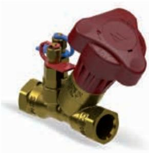
Балансировочный вентиль с резьбовыми присоединениями для систем отопления и водоснабжения. Вращение маховика регулирует размер проходного отверстия, меняя расход и перепад давления. Функция запирания, гидравлической балансировки, измерения расхода и перепада давления при помощи набора BVT-SET. Поля допуска коэффициента Kvs +/-3%. Значения Kv для каждого положения маховика вентиля для всех диаметров приведены в таблице.
