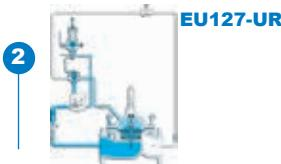
2 Автоматический клапан контроля уровня жидкости
