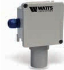
Детектор утечки газа UR20S обнаруживает наличие взрывоопасных и ядовитых газов на тепловых электростанциях и в промышленных помещениях. Все модели могут быть подключены к центральным устройствам CIVIC1 (один детектор) и CIVIC4 (до четырех детекторов), либо к другому центральному устройству с входным сигналом 4 - 20 mA (обычные центральные устройства, совмещающие функции противопожарной и противокражной сигнализации).
