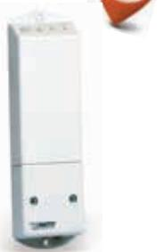
Однозонный приемный модуль для коммутации с радиотермостатами ВТ. Один термостат может управлять несколькими модулями. Режимы работы: автоматический, инициализации. Выход 12 А. Радиус приема 100м на открытой местности. Частота 868 МГц. Степень защиты IP 44.
