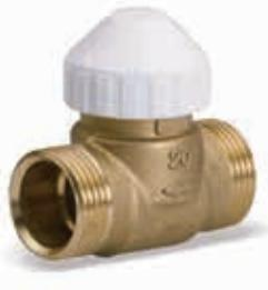
Двухходовой латунный зональный клапан для фанкойлов. Управление (открыт-закрыт). осуществляется сервоприводом (22C, 26LC и EMUJC). Номинальное давление 16 бар. Макс. рабочая температура 100 °С. Ход штока 2,5 мм.
