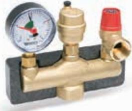
Группа безопасности котла для защиты закрытых систем отопления до 50 кВт. Включает в себя предохранительный клапан с порогом срабатывания 3 бара, автоматический воздухоотводчик (с запорным клапаном) MKV10R и манометр MHR63/4-3/8", установленные на латунной консоли (в теплоизолирующем кожухе). Подключение 1" ВР.
