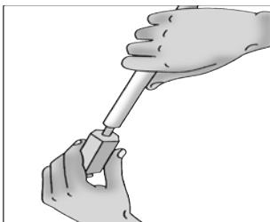
Проконтролировать цилиндрическую (нерасплющенную) форму конца трубы.
