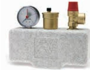
Группа безопасности котла для защиты закрытых систем отопления до 50 кВт. Включает в себя предохранительный клапан с порогом срабатывания 3 бара, автоматический воздухоотводчик (с запорным клапаном) MKV10R и манометр MHR63/4-3/8", установленные на стальной консоли (с гальваническим покрытием). Подключение 1" ВР. Теплоизоляция, класс огнезащиты II, без хлорфторуглеродов (фреонов).
