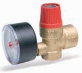
Предохранительный сбросной мембранный клапан с фиксированным порогом срабатывания (сбросное отверстие на один размер больше присоединительного). С манометром 0-4 бар с присоединением 1/4". Допустимо использование с антифризом (гликоль) до 50%.
