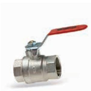
Шаровый кран из латуни, полнопроходной, шар хромирован, тefлоновое уплотнение шара, двойное уплотнение шпинделя, красная ручка-рычаг. Усиленная конструкция. Рабочее давление до 20 бар. Максимальная температура 110 °C. Для воды, воздуха и нефтепродуктов, топлива и сжатого воздуха. Внутренняя резьба с обеих сторон.
