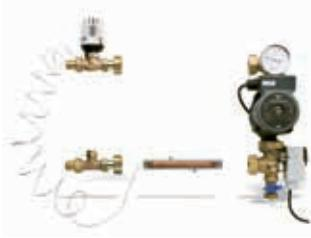
Готовый к монтажу, компактный регулирующий модуль для систем напольного отопления тепловой мощностью 8-10 кВт. Диапазон регулирования температуры подачи 20-50 °C. Встроенный термометр обеспечивает визуальный контроль температуры подачи. Поставляется с готовым электрическим подключением насоса и ограничителем температуры. Накидные гайки с плоским уплотнением для монтажа с обеих сторон на 1" коллекторных патрубков.
