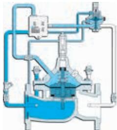
Предотвращает превышение заданного значения максимального расхода в трубопроводе водоснабжения и служит для контроля расхода в трубопроводе. Основной клапан работает под управлением пилотного вентиля и расходомерной диафрагмы, которая установлена на входном (иногда на выходном) фланце и позволяет контролировать значение расхода через измеряемое значение скорости протока в м/с.
