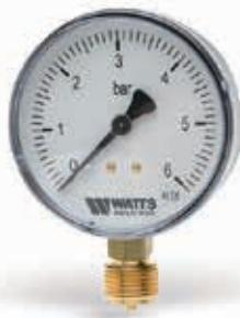
Манометр радиальный. Пластмассовый корпус. Резьба подключения – 1/4". Класс точности – 2,5 (1,6 по запросу).
