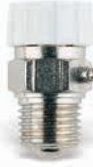
Ручной воздушный клапан, со сбросным отверстием. Корпус – латунь CW617N с никелевым покрытием. Макс. давление 10 бар.
