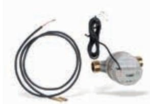
Набор теплосчетчика полученной энергии для гелиосистем подключается к гелиоконтроллеру (напр. LCD Advanced или LCD PLUS). Состоит из расходомера (1,5 м³/ч, 3/4", 90 °C), внутритрубного температурного датчика и крепежных стяжек.
