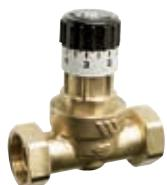
Перепускной клапан. Подключение через накидные гайки 3/4". Макс. рабочее давление 10бар. Макс. рабочая температура 110°C. Диапазон установки: 0,03 - 0,5 бар. Макс. содержание гликоля до 50%.
