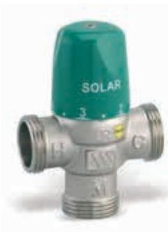
Термостатический подмешивающий клапан для гелиосистем, обеспечивающий подачу потребителю горячей питьевой воды в заданном температурном диапазоне 30° – 65°C. Исходная установка верхней границы 50 °C служит для защиты от ожога. Корпус – латунь, имеется также исполнение латунь с никелевым покрытием. Макс.температура, подаваемая от теплоаккумулятора: 110 °C. Расход 63 л/мин при давлении 3 бар. Любое монтажное положение.
