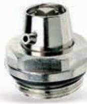
Ручной воздушник – клапан Маевского, самоуплотняющийся благодаря наличию уплотнительного кольца. Вращаемый "носик", корпус – латунь с никелевым покрытием. Открывается ключом или монетой.
