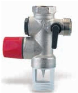
Группа безопасности для систем горячего водоснабжения. Прямой корпус, с интегрированным предохранительным клапаном, запорным краном, доступным для проверки обратным клапаном, ручкой для ручного слива воды через сбросное отверстие предохранительного клапана. Порог срабатывания предохранительного клапана 7 бар. Присоединительная резьба 3/4". Сбросное отверстие предохранительного клапана 1" НР.
