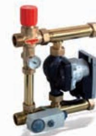
Готовый к монтажу, компактный регулирующий модуль для систем напольного отопления тепловой мощностью до 15 кВт. Функция автономной циркуляции (за счет байпаса). Поставляется с готовым электрическим подключением насоса и ограничителем температуры. Накидные гайки с плоским уплотнением для монтажа с обеих сторон на 1" коллекторных патрубков. Прошел тест на давление, упакован в коробку.
