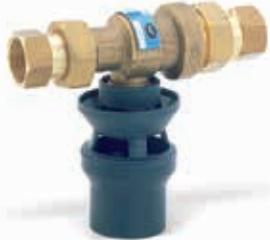
Упрощенный прерыватель обратного тока для подключения к системе водоснабжения оборудования с малыми диаметрами трубопровода и невысоким классом опасности загрязнения воды, таким как отопительные котлы более 45 кВт или умягчители воды. Внутренняя резьба 1/2" – 3/4". Макс. температура воды 65 °С. Макс. рабочее давление 10 бар. Присоединение промежуточной камеры DN 40. Корпус латунь, пружина из нержавеющей стали, уплотнение – резина, воронка – пластмасса.
