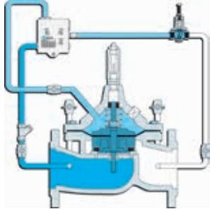
Мембранный редукционный клапан автоматического действия для питьевой воды (с пилотным вентилем). Снижает высокое входное давление до заданного, более низкого давления на выходе. Установленное на пилотном вентиле значение выходного давления поддерживается неизменным на выходе редукционного клапана независимо от колебаний давления и расхода на входе. Редукционный клапан версии -UR дополнительно оснащен блоком регулирования скорости реагирования EU900.
