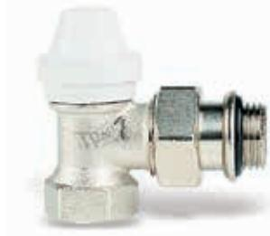
Никелированный вентиль отсечной, для гидравлической балансировки, угловой, внутренняя резьба – для стальной или медной трубы. Разъемный штуцер с уплотнением для подключения к радиатору. Пластмассовый колпачок.
