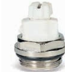
Ручной воздушный клапан для радиаторов с регулируемым положением сбросного отверстия. Сброс открывается вручную с помощью отвертки или монеты. Корпус латунь CW617N с никелевым покрытием. Пластмасса маховика и сбросного "носика" усиlena стекловолокном. Резьба для установки на радиаторе укомплектована уплотнительным кольцом. Макс. давление 10 бар.
