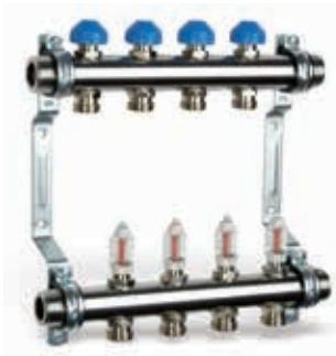
Коллектор 1" для напольного отопления, состоящий из двух патрубков из нержавеющей стали круглого сечения, смонтированных на звукоизолирующих кронштейнах. Возможность разностороннего подключения (1" HP с плоским уплотнением). Выходы: 3/4" HP с евроконусом, расстояние между отводами 55 мм. Минимальная величина заглубления при скрытом монтаже.
