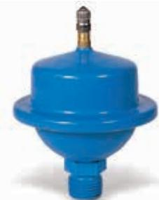
Амортизатор гидроударов с мембраной (эластомер) для стиральных машин, посудомоечных машин, в любых точках водоразбора систем питьевого водоснабжения. Может монтироваться в любом положении. Корпус из нержавеющей стали, окрашенный. Предварительная закачка до давления 3 бар. Макс. пиковое давление 13 бар. Температура воды до 90 °C.
