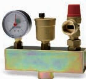
Группа безопасности котла для защиты закрытых систем отопления до 50 кВт. Включает в себя предохранительный клапан с порогом срабатывания 3 бара, автоматический воздухоотводчик (с запорным клапаном) MKV10R и манометр MHR63/4-3/8", установленные на стальной консоли (с гальваническим покрытием). Подключение 1" ВР.
