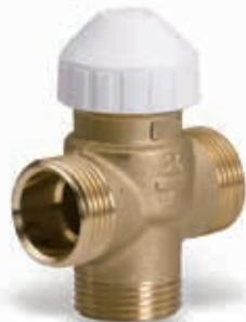
Трехходовой латунный зональный клапан для фанкойлов. Управление (открыт-закрыт) осуществляется сервоприводом (22C, 26LC, EMUJC). PN 16 бар. Макс. рабочая температура 100 °С. Ход штока 2,5 мм. Используется для смешивания и перенаправления потоков теплоносителя.
