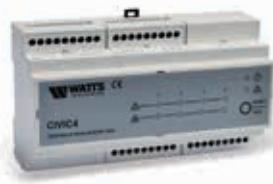
Центральное устройство для подключения детекторов утечки газа UR13 или UR 20S с светодиодной индикацией (электропитание, сбой, газовая сигнализация) и звуковой сигнализацией. Управляющий выход для газовой сигнализации и выход с открытым коллектором для сигнала сбоя. Корпус из самогасящегося пластика. Монта на рейке DIN.
