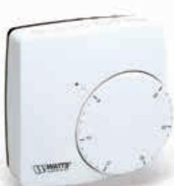
Электронный комнатный термостат для систем напольного отопления. Режимы работы: комфортный, ночной, управление от таймера. Светодиодная индикация состояния. Диапазон регулирования 5 – 30 °C, гистерезис 0,5 К. Регулирование по встроенному термодатчику или по внешнему датчику (опция). Бесшумные триаковые контакты. Мощность до 15 Вт. Подключение либо напрямую к сервоприводам 22C и 26LC, либо через коммутационный модуль WFHC. Степень защиты IP30.
