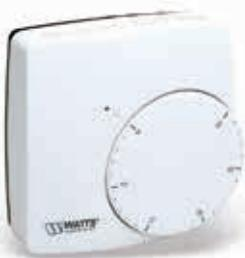
Электронный комнатный радиотермостат. Режимы работы: комфортный, ночной (понижение на 4К). Светодиодная индикация состояния. Диапазон регулирования: 5 - 30°C. Гистерезис 0,3К. Регулирование по встроенному датчику. Радиус приема 100м на открытой местности. Питание: 2 батарейки 3В (CR2430), 2 года автономной работы. Степень защиты IP 30.
