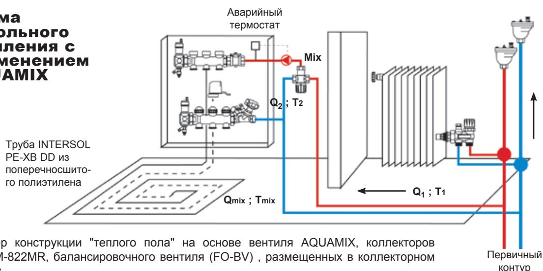
Пример конструкции "теплого пола" на основе вентиля AQUAMIX, коллекторов 822MM-822MR, балансировочного вентиля (FO-BV), размещенных в коллекторном шкафу.
