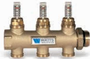
Одиночный модульный латунный коллектор подающего трубопровода с встроенными расходомерами FLMR, с предустановленными уплотнениями и фиксирующей гайкой и фиксирующими вентилями балансировки. Перепад давления 1,0 бар. Диапазон регулирования 0 – 6 л/мин. Kvs на отводах петель отопления: 1,8. Межосевое расстояние между выходами 50мм.
