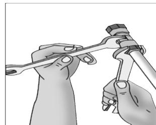
Полностью затянуть ответную резьбовую часть фитинга с помощью ключа.
