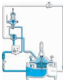
Плавно закрывается при возрастании уровня воды в резервуаре выше заданной высоты водяного столба, плавно открывается при понижении уровня в резервуаре относительно установленного значения. Имеет более широкий диапазон регулирования уровня по сравнению с поплавковым клапаном контроля уровня. Монтируется дистанционно и обеспечивает удобный доступ и регулирование.
