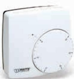
Электронный комнатный термостат для систем напольного отопления. Режим работы: комфортный. Светодиодная индикация состояния. Диапазон регулирования 5–30 °C, гистерезис 0,5 К. Регулирование по встроенному термодатчику. Бесшумные триаковые контакты. Мощность до 15 Вт. Подключение либо напрямую к сервоприводам 22C и 26LC, либо через коммутационный модуль WFHC. Степень защиты IP30.
