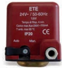
Электротермический привод (открыт-закрыт) для зональных клапанов VU и V2/3BMХЕ. Опция: нормально-открытый микропереключатель для дополнительных команд (управление насосом, КИП). Байонетный разъем для присоединения к корпусу клапана. Устройство ручного управления клапаном. Потребляемая мощность: 18 Вт. Ход штока 4 мм. Усилие 250 Н. Время позиционирования 4 мин.
