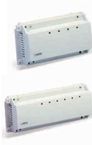
Коммутационный модуль основной (главный, master) на 4 или 6 зон для подключения проводных термостатов (например WFHT-LCD, Milux, BT-D) к сервоприводам (22C, 26LC), реле насоса (8 A), IP 20, модульная конструкция. К каждой зоне можно подключить от 1 до 4 сервоприводов 22C, 26LC. Светодиодная индикация состояния.
