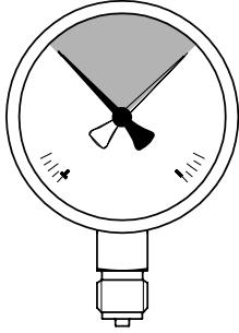
Манометр должен быть закреплён в не подверженном сотрясениям месте и расположен таким образом, чтобы было обеспечено удобное считывание показаний.
