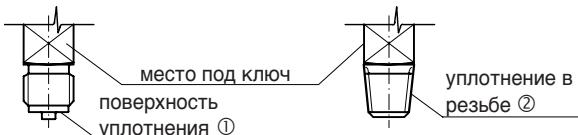
Для установки прибора в положение, обеспечивающее максимальное считывание показаний рекомендуется использовать стяжной замок или накидную гайку.
