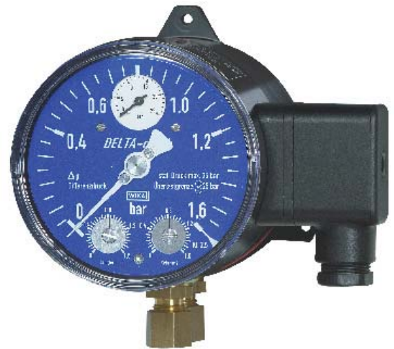
DELTA-comb, модель 702.02.100, с двумя микропереключателями, клеммным блоком (опция) и переходниками с накидной гайкой (опция)
