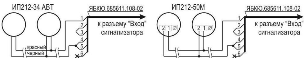
Рисунок Г.3 – Схема подключения пожарных извещателей
