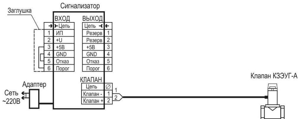
Рисунок Г.1 – Типовая схема включения сигнализатора С3-2-2АГ
