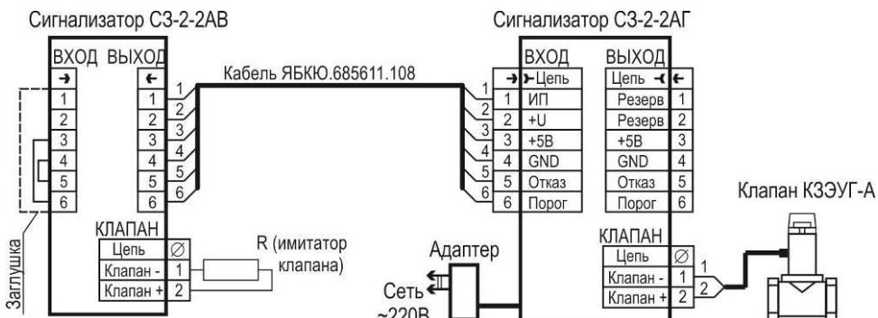
Рисунок Г.2 – Типовая схема включения сигнализатора С3-2-2АВ
