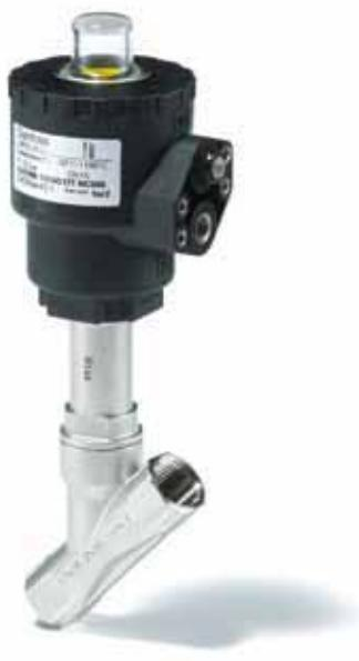
AV210 — угловые пневматические клапаны, предназначенные для использования в жестких промышленных условиях. Клапан может работать при очень высоких температурах и значениях вязкости рабочей среды и нечувствителен к частицам грязи, содержащимся в этой среде. Клапаны выпускаются с корпусом из бронзы (RG5/бронза) или нержавеющей стали (AISI316).
