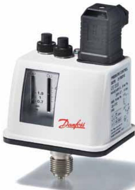
Серия BCP предназначена для автоматизации и технологической защиты паровых и водогрейных котлов. Реле давления оснащено однополюсным перекидным контактом, который меняет положение в зависимости от соотношения давления среды и уставки. В случае ответственных применений рекомендуется использовать реле с функцией защиты.
